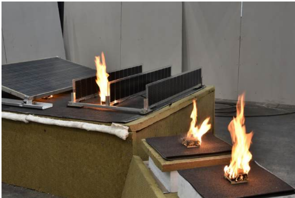
Brandtest: Das Feuer breitete sich unter der herkömmlichen Solaranlage aus, konnte aber mit den vertikalen Paneelen eingedämmt werden.
